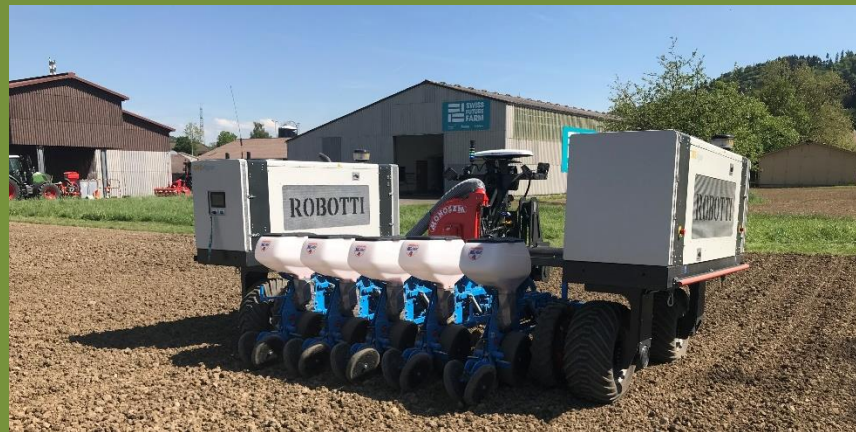
Der autonom fahrende Geräteträger „Robotti“ der Firma Agrobotics; hier bei der Einzelkornsaat von Mais im Einsatz auf der Swiss Future Farm.
